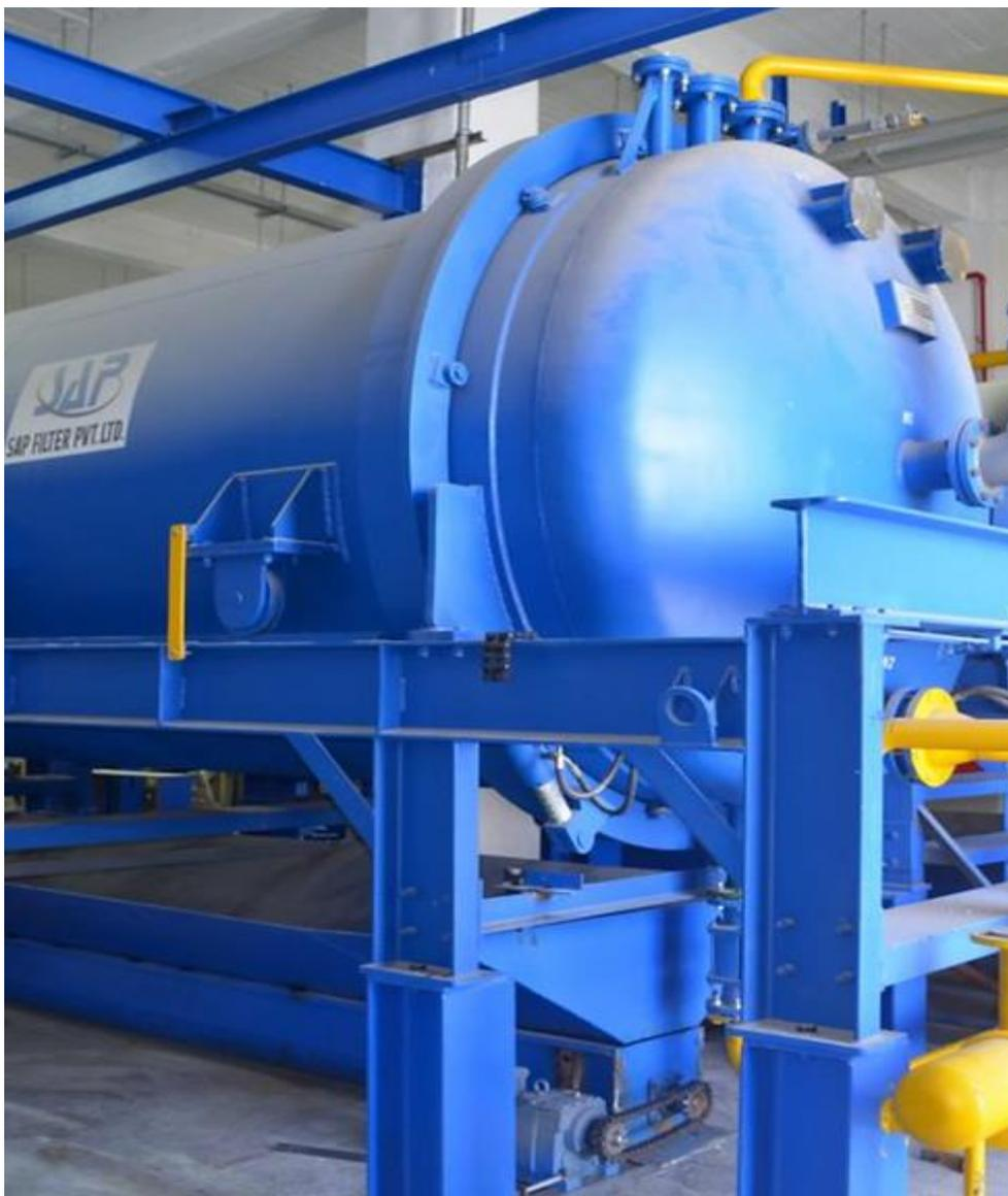
Он используется для фильтрации жидкостей с высоким содержанием твердых частиц в пищевых маслах, химической, пищевой и фармацевтической промышленности.
