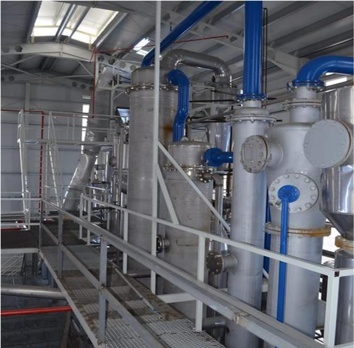
Процесс удаления растворителя из мицеллы включает множество этапов, таких как фильтрация, дистилляция и удаление оставшегося растворителя путем паровой дистилляции мицеллы.
