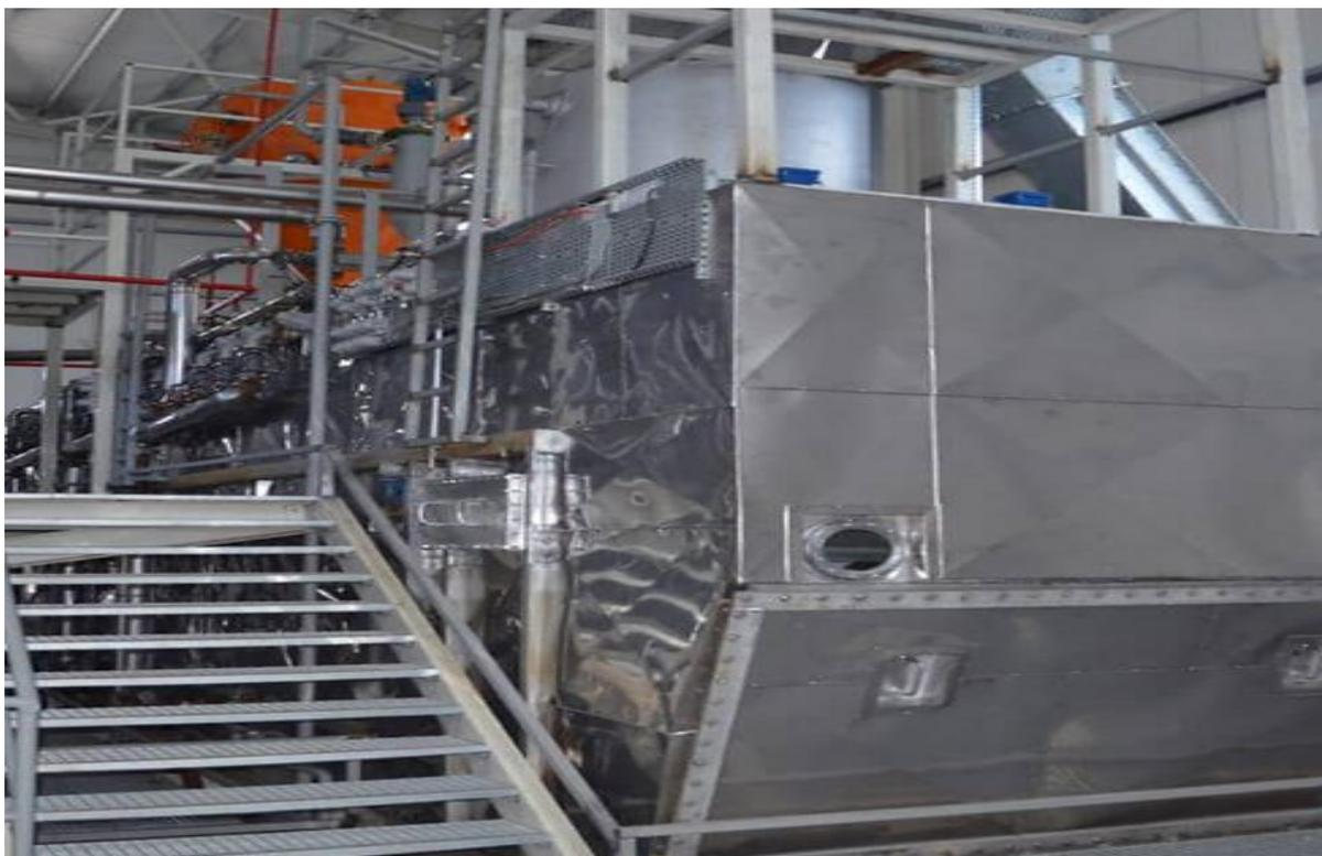
Принцип работы экстракторов непрерывного действия, которые имеют низкие эксплуатационные расходы и автоматизацию, основан на сравнении хлопьев семян с наибольшим содержанием масла с мицелием с наибольшей концентрацией масла (противоток).
