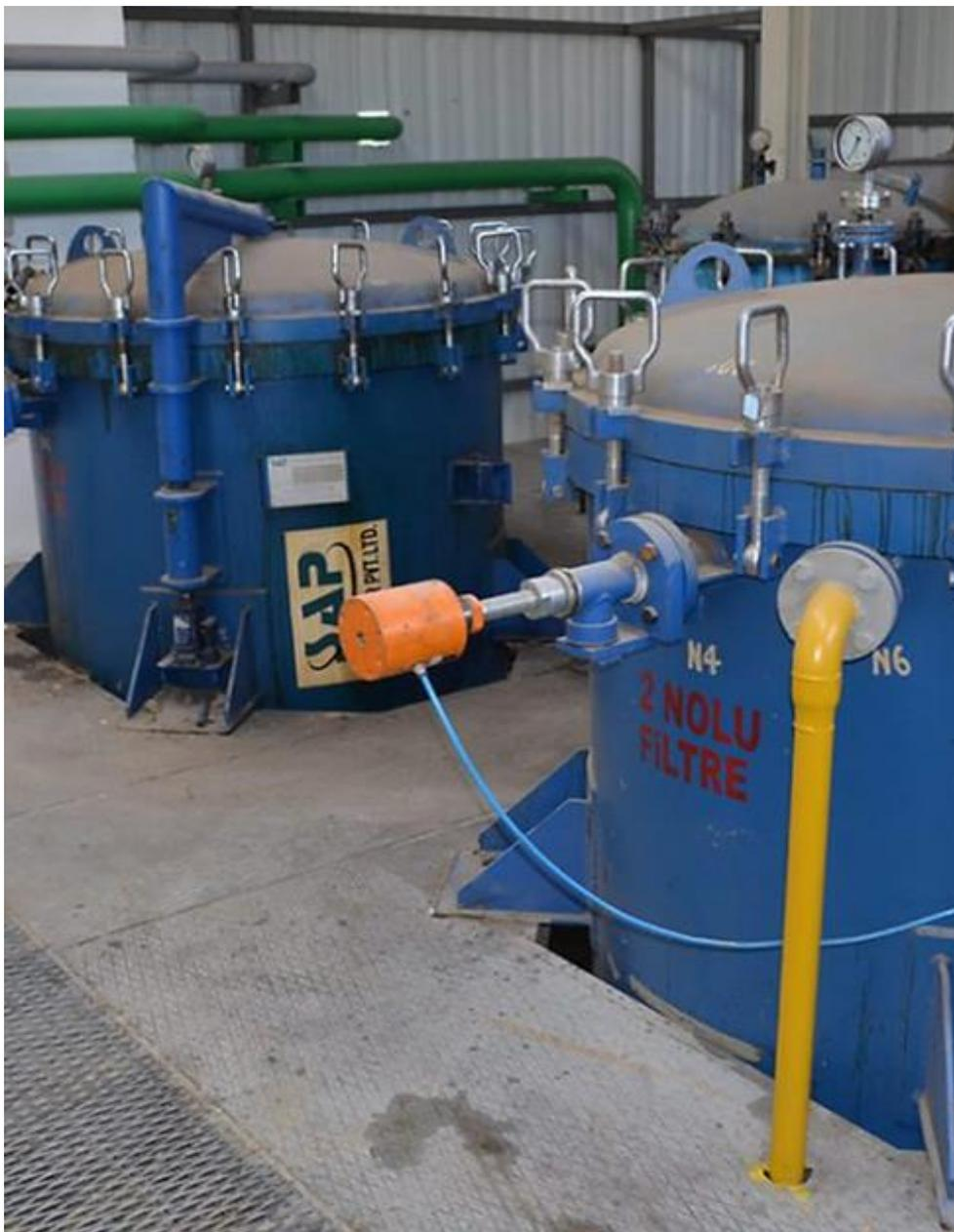
Пластинчатые фильтры – это продукт самой современной проверенной технологии. Этот фильтр широко используется в различных отраслях промышленности по всему миру. Пластинчатый фильтр под давлением – это простейшая, наиболее экономичная система и высокоэффективная технология в эксплуатации, для его работы не требуется никакой перемотки и использовании рабочей силы, а закрытая система обеспечивает чистоту и простоту использования.
