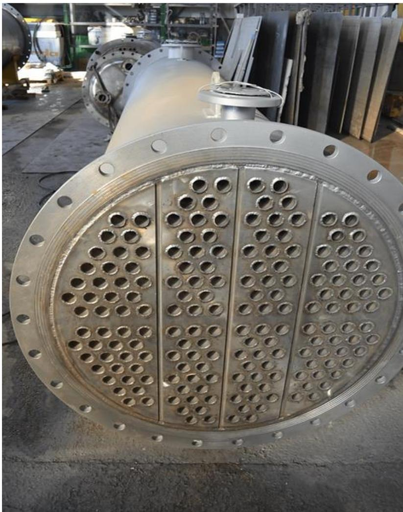
Трубчатые теплообменники относятся к классу теплообменников, используемых во всех процессах. Трубчатые теплообменники – это теплообменники из труб, предназначенные для передачи тепла между жидкостями при высоких температурах. В трубчатых теплообменниках поверхность теплопередачи это поверхность труб.
