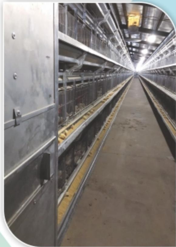
**AZ1200 и AZ1000** клетка для выращивания цыплят предназначена для предотвращения попадания корма в глаза и смешивания его с намётом. Цыплят можно кормить из отверстий размером 30x40 мм на кормушке с первого дня их рождения. Плита регулировки подачи корма расположенная в передней части этих отверстий, легко регулируется ручкой вдоль кормушки и позволяет кормить цыплят с первого до последнего дня.
