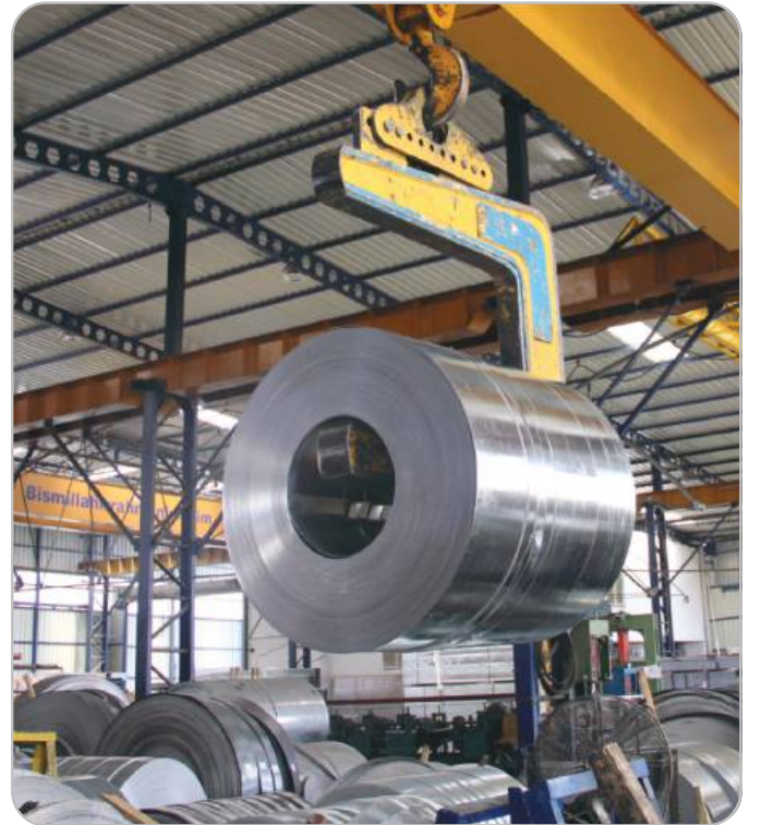
0,8MM - 6,00MM ARASI DİLİNİMİŞ GALVANIZLI SAC / 0,8MM - 6,00MM Galvanized Slitted Coil / Chapa Galvanizada En Rodajas De Entre 0,8 Mm Y 6,00 Mm De Espesor / Щелевая катушка / 0,8MM - 6,00MM/ لفائف الصلب المجلفن
