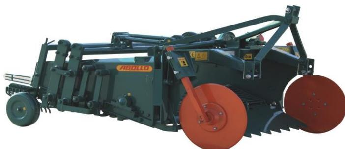
Оборудование соединено через трехточечное соединение к трактору и берет мощность через ВОМ трактора. Средняя работоспособность оборудования при сбалансированном отношении к качеству почвы - достигает до скорости 2,5 км/час. Техника удаляет 2 ряда посаженной грядки на максимальном расстоянии 75 см. Благодаря системе ножей с крутым углом 26 градусов, она глубоко заходит в землю и легко выкапывает клубни
